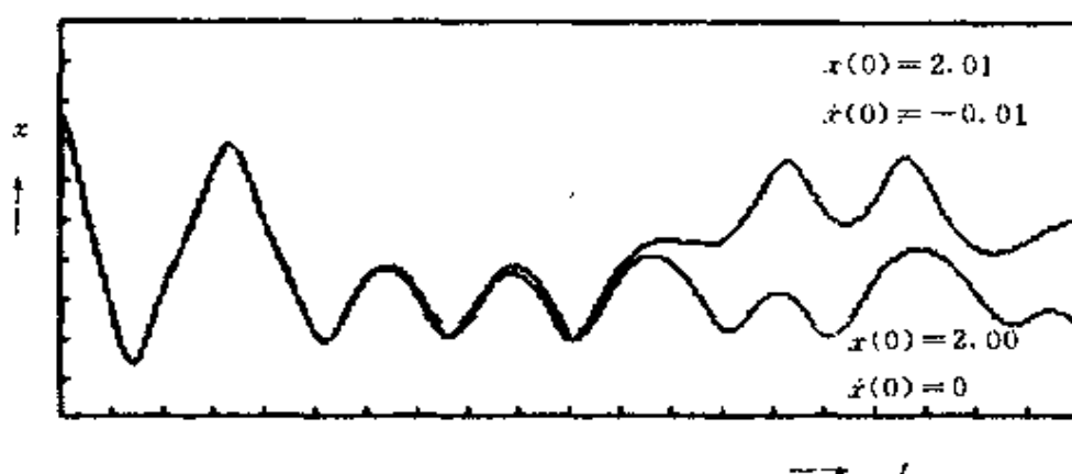
图 9-1 方程 \ddot{x} + 0.3\dot{x} - x + x^3 = 0.3\cos 1.2t 两个邻近初始条件的 x-t 曲线
