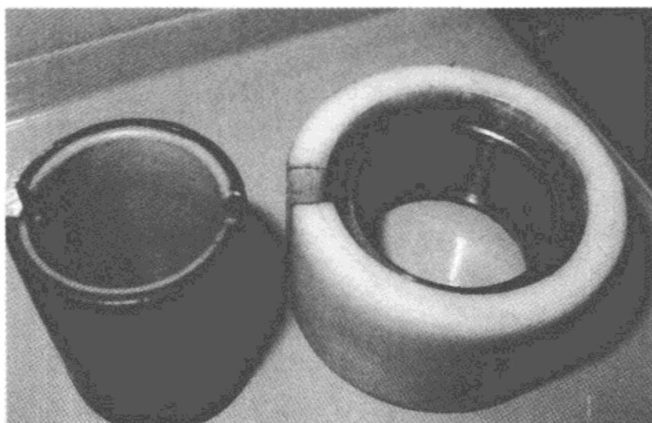
图 12.5 锰钢制成的衬套轴承的零件,安装一个正确尺寸的聚合物衬套来抑制尖叫声
