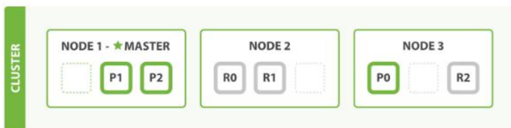
Figure 4. 拥有三个节点的集群——为了分散负载而对分片进行重新分配
