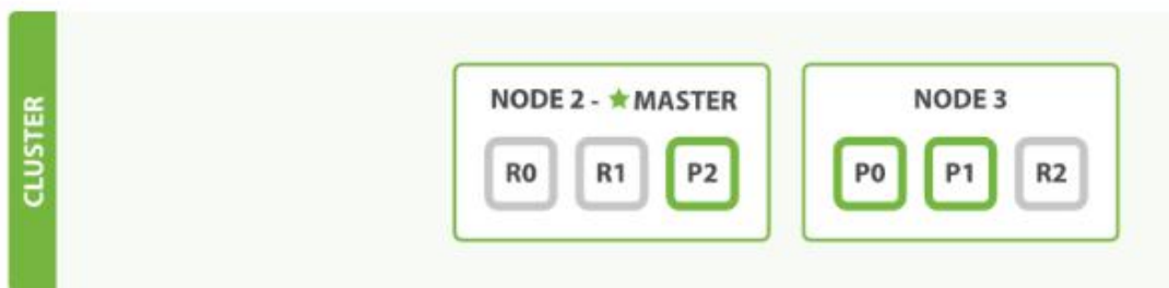
Figure 6. 关闭了一个节点后的集群
